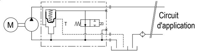
Si le distributeur de votre installation limite le retour de l'huile au réservoir à moins de 5 l/mn ou s'il est de type « centre fermé », un tuyau de drain doit être installé entre la valve By-Pass et le réservoir hydraulique du véhicule pour assurer une circulation d'huile suffisante pour permettre un bon refroidissement de la pompe.
